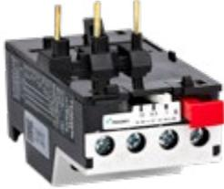
JRS1系列热过载继电器（以下简称“热继电器”），适用于交流50Hz/60Hz、电压至690V及以下、电流至80A的长期工作或间断长期工作的交流电动机的过载保护和断相保护。
